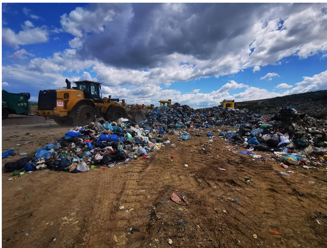
Slika 2. Postupak četvrtanja uzorka pomoću mehanizacije.
